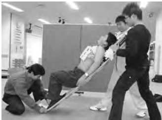
図1 AutoPulseを装着した状態で角度をつけて圧迫部位のずれを計測
