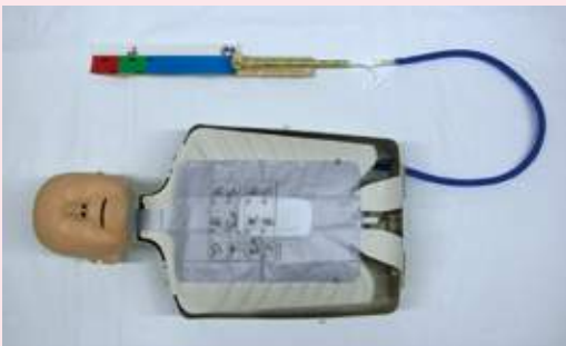
▲まず、訓練人形の胸部カバー、肋骨板及びクリッカーとクリッカー駆動部を取り外す。
